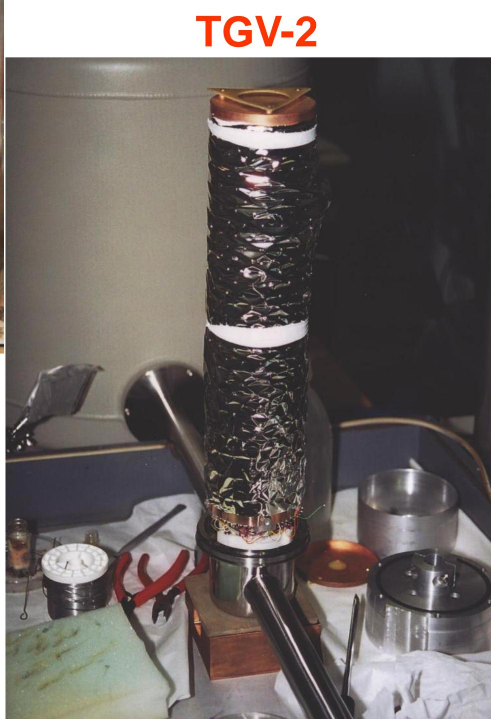
**Detectors:** 32 HPGe  $\varnothing$  60 mm x 6 mm
